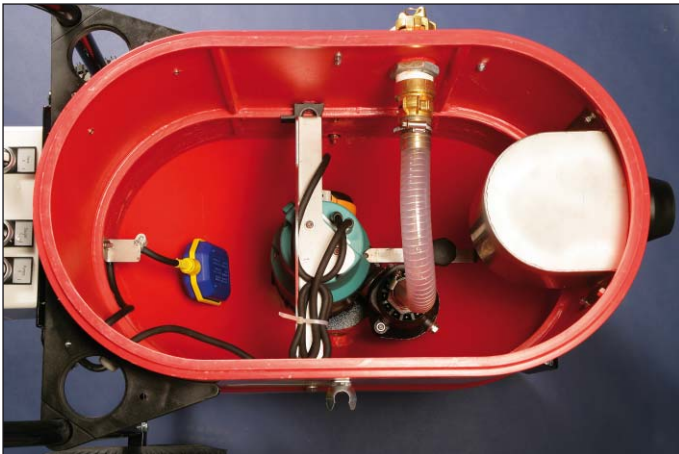
Innenansicht mit eingesetzter Pumpe und Schwimmerschalter für Saugmotor und Pumpe.
